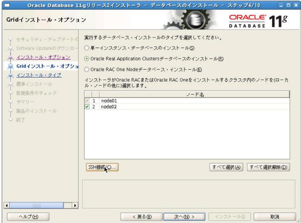
ノード間でパスワード不要の SSH 接続を構成します。oracle ユーザーの OS パスワードを入力して「設定」をクリックします。
